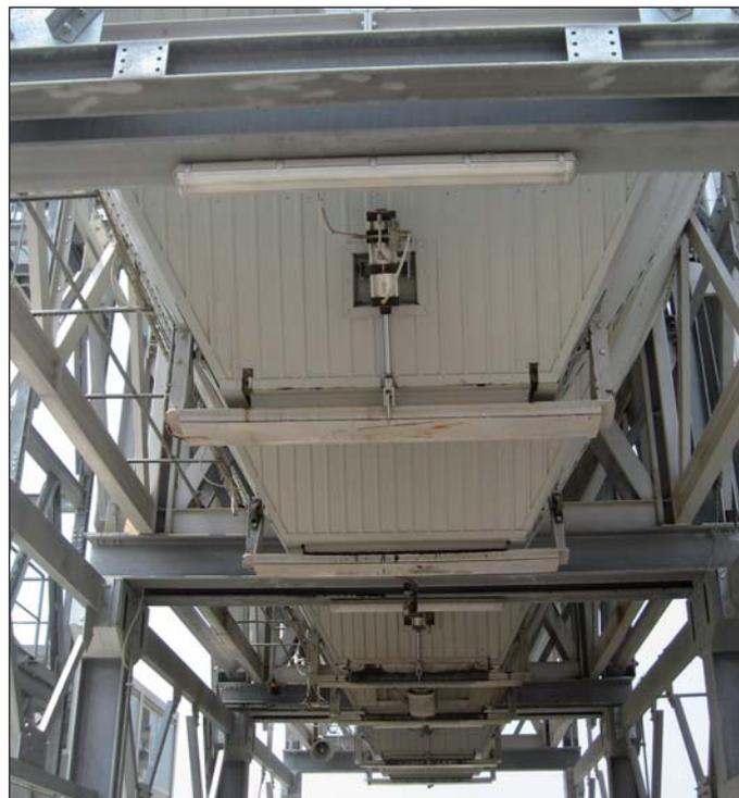
Figura 16 - Le bocche di scarico del materiale prodotto
