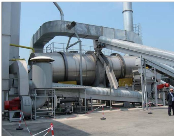
Figura 15 - Il forno rotante di produzione asfalto
