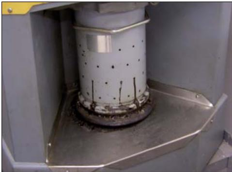
Figura 11 - Il costipamento del conglomerato bituminoso freddo con la pressa giratoria
