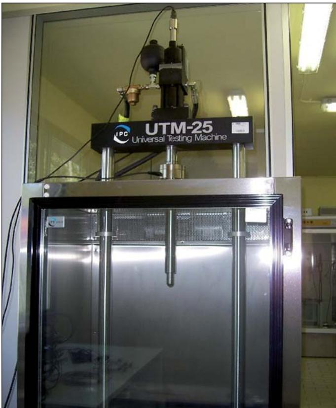
Figura 7 - La macchina dinamica ad ampio spettro di frequenze
